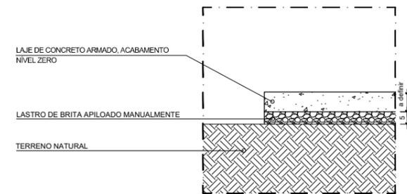
DET. 01 | CORTE ESQUEMÁTICO DO PISO
